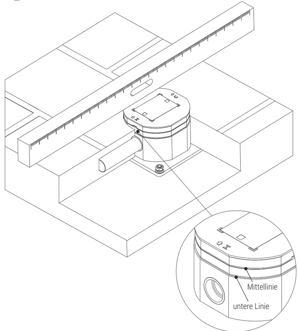
Achten Sie, wie bereits bei Schritt 1 erwähnt darauf, dass sich die fertige Höhe des Bodens einschließlich Bodenbelag (z.B. Fliesen) mindestens bei der untersten Linie und maximal bei der Mittellinie befindet!
