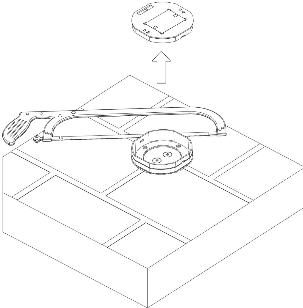
Demontieren Sie nun den Schutzabdeckung und kürzen die überstehenden Kunststoffränder der DF-Box mit Hilfe einer Säge oder eines scharfen Messers auf die Endhöhe des fertigen Bodens.
