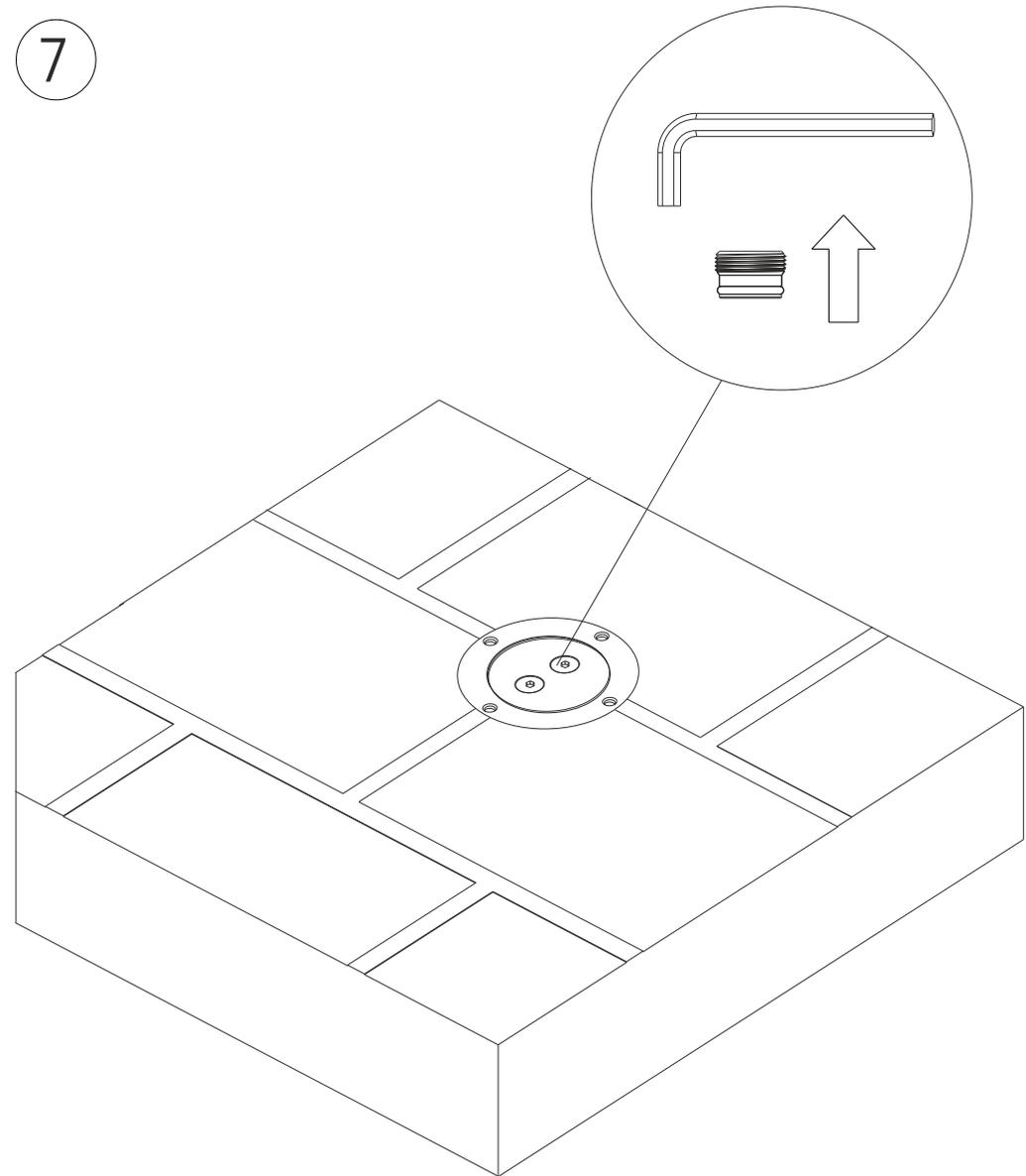
Entfernen Sie jetzt die beiden Verschluss-Verschraubungen der oberen Wasseranschlüsse mit dem im Lieferumfang befindlichen Inbusschlüssel.
